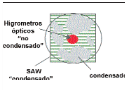
Fig.7: Presencia de condensado no uniforme.
