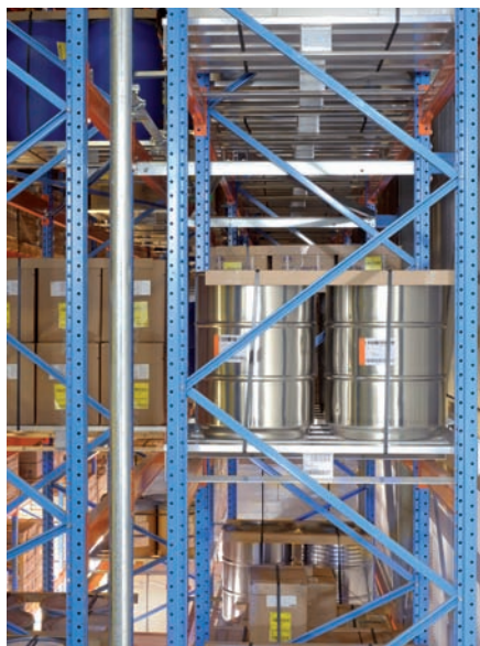
Almacén de gran altura con tres pasillos, totalmente automático, para almacenar paletas a doble profundidad en 4.772 ubicaciones.
