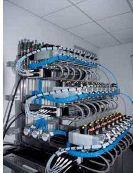
zación a nivel de sensor/actuador se sitúa el terminal de válvulas CPX/MPA instalado en un armario de maniobra. Gracias a su concepto de control flexible, el terminal de válvulas puede utilizarse como un módulo de E/S para la conexión de todos los dispositivos de señal de retroalimentación, actuadores y válvulas de proceso. Actualmente controla a 4.000 válvulas de diafragma y a otras válvulas de proceso en las operaciones de producción farmacéuticas.
