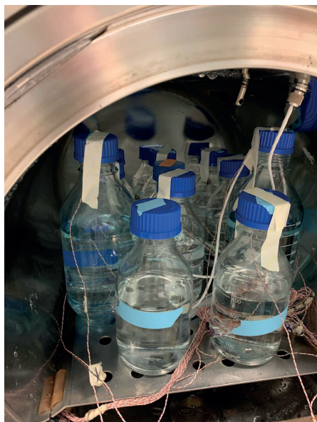
Figura 3. Patrones de carga validados en los que se puede ver el uso de sonda móvil de control.
