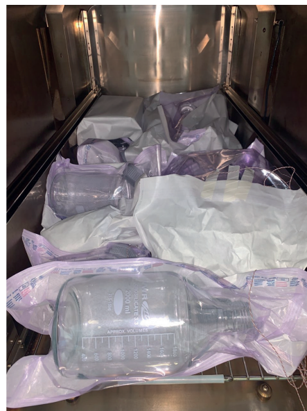
Figura 3. Patrones de carga validados en los que se puede ver el uso de sonda móvil de control.
