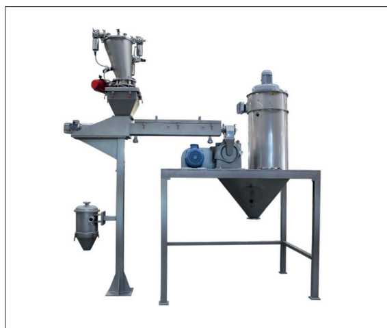
Molino criogénico construido íntegramente en acero inoxidable, con carenados de protección. Incluye un sistema de transporte por vacío para la alimentación del equipo, evitando manipulaciones del operario y todo riesgo de contaminación cruzada.
