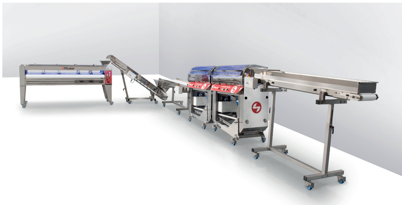
Figura 2. Automatización integral. Línea de producción completa de equipos de poscosecha para cannabis medicinal.
