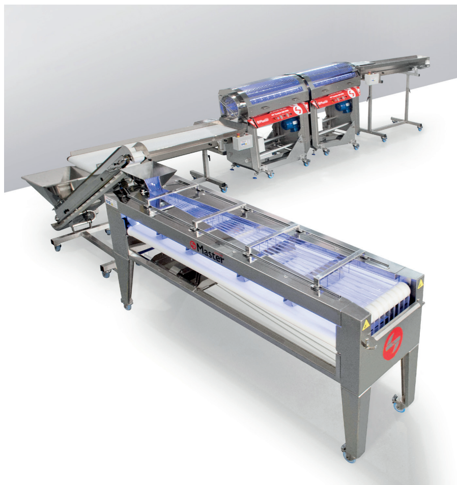
Figura 1. Proceso de automatización en fase de poscosecha. Trimeado y clasificación de flores de cannabis para su uso medicinal.
