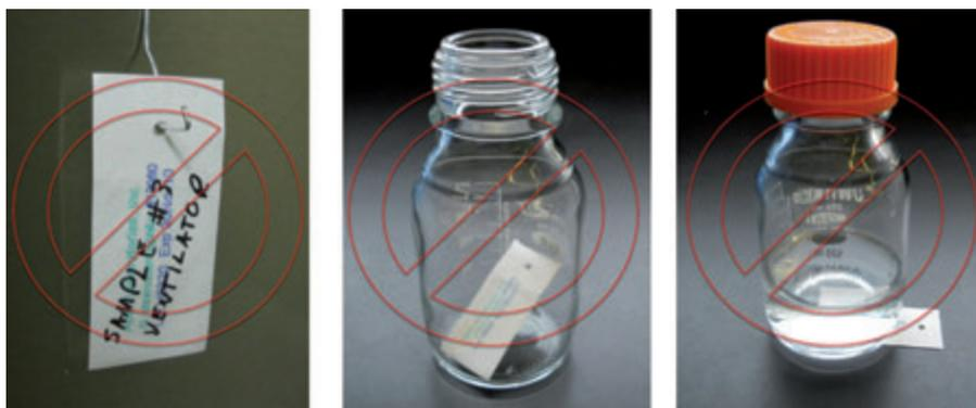
Figura 4. Ejemplos de empleo INCORRECTO DE BI: escribir sobre el frontal del envase y colocar el BI dentro o debajo de un envase.
