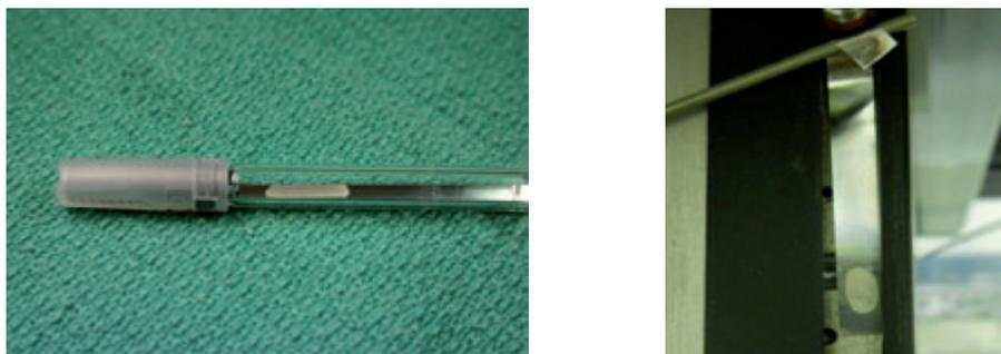
Figura 6. Ejemplos de tiras de BI en una zona muerta (fotografía de la izquierda) y colgada de un elemento fijo del aislador (fotografía de la derecha)
