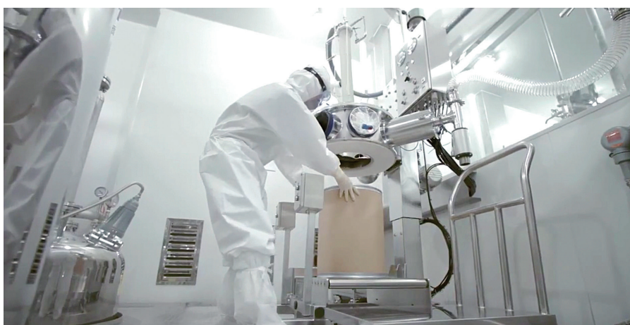
Descarga de un Filtro Secador en bolsas con un film continuo.
