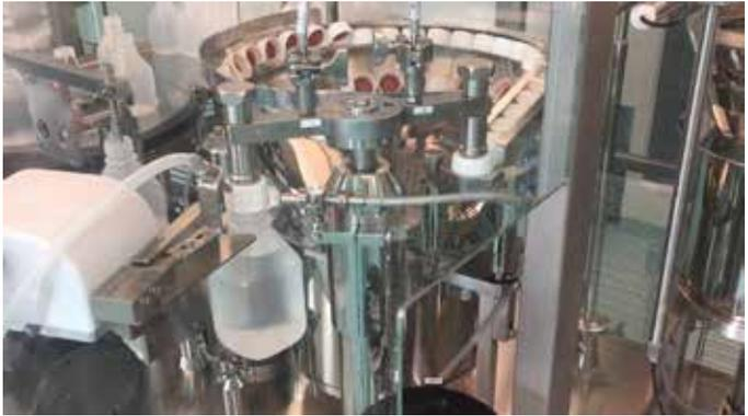
Fig. 5 - Proceso de cerrar recipientes con un tapón de rosca manejado por una pinza robótica que podría agarrar viales y recipientes con diferentes formas y tapas - Foto: Steriline S.r.l.
