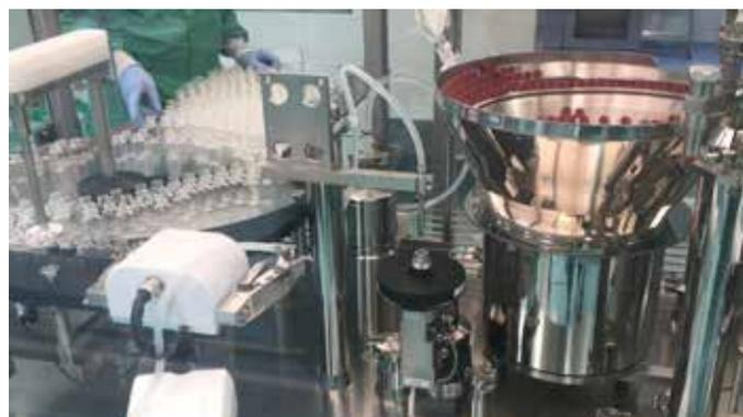
Fig. 4 - Proceso de llenar un frasco de cristal con la RVFCM - Foto: Steriline S.r.l.
