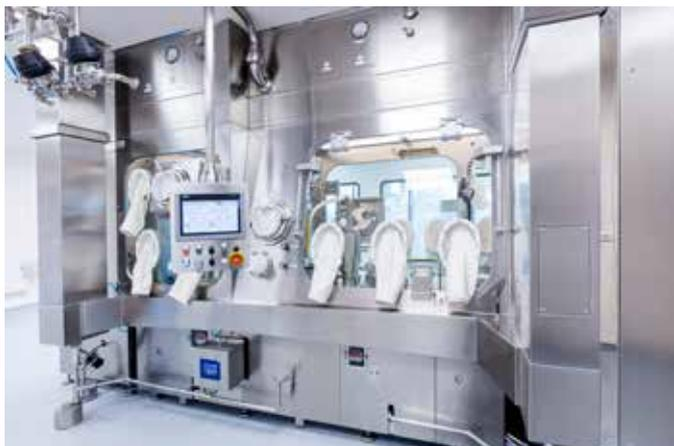
Fig. 1 - La máquina robótica llenadora y taponadora de frascos RVFCM50 de Steriline presenta puertos para guantes a ambos lados de la máquina para permitir el acceso completo a la línea - Foto: Steriline S.r.l.
