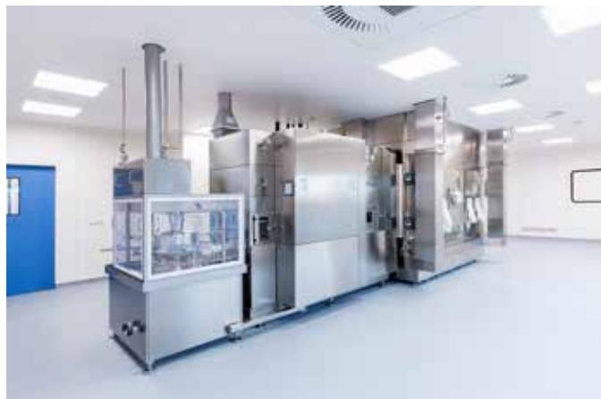
Fig. 2 - La seguridad de los operadores es primordial con los fármacos citotóxicos. La línea está encerrada en un aislador y la intervención del operador se mantiene al mínimo - Foto: Steriline S.r.l.
