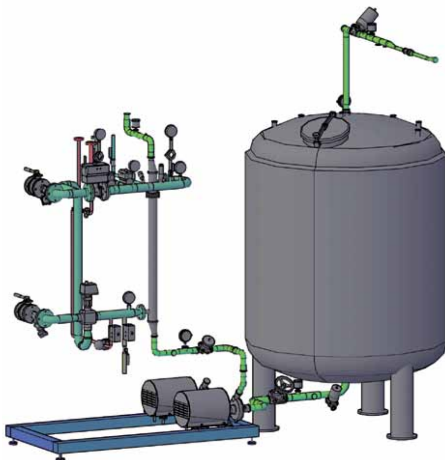
Figura 1: Perspectiva 1 de un bastidor de almacenamiento y distribución de Agua Purificada
