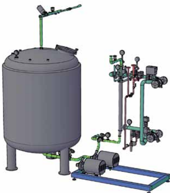
Figura 2: Perspectiva 2 de un bastidor de almacenamiento y distribución de Agua Purificada
