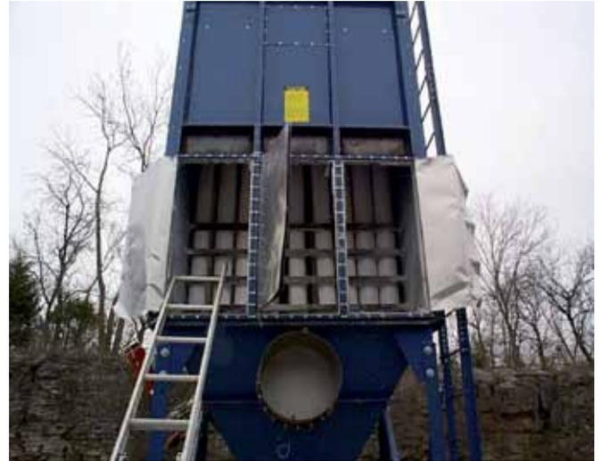
Figura 3: En este filtro se le ha suprimido la primera fila de mangas. Las barras soldadas impedirán la obstrucción del área de venteo.
